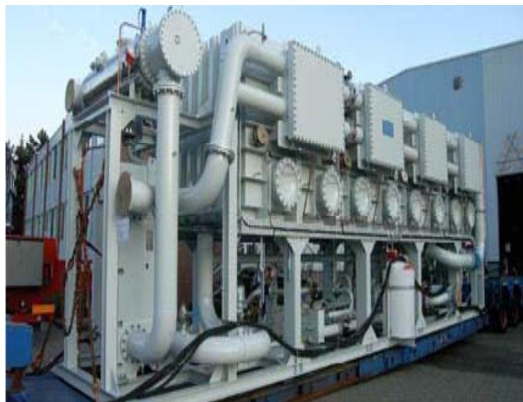
و- تولید اب شیرین از اب دریا با سیستم تبخیری اب شیرین کن (Multi stage flash process with brine recycling)
